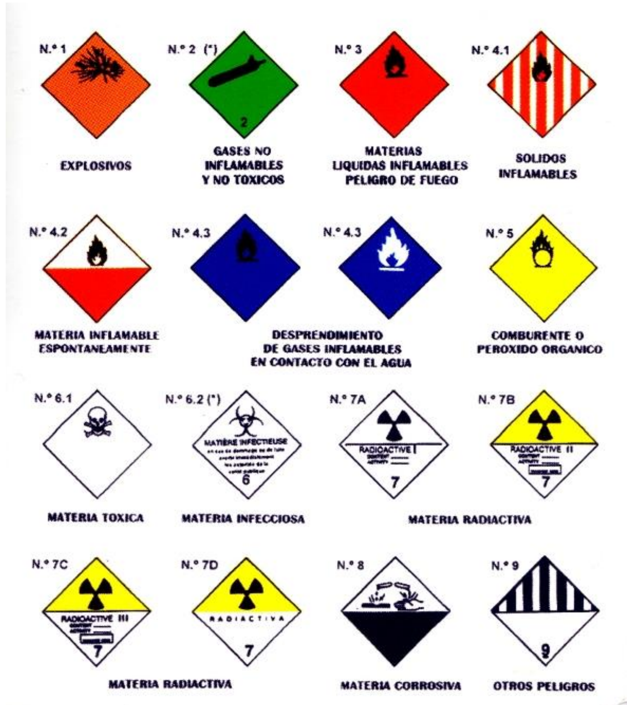
Ilustración 2. Pictografía Productos Químicos Peligrosos
