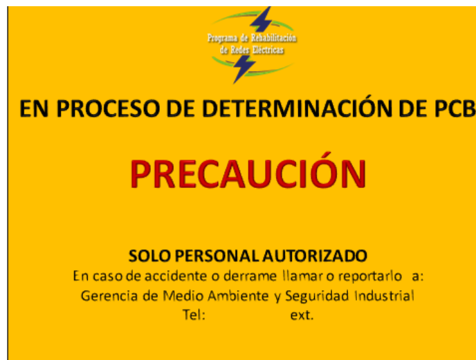
Ilustración 1. Etiqueta para Identificación de Transformadores “En proceso de determinación de PCB”
