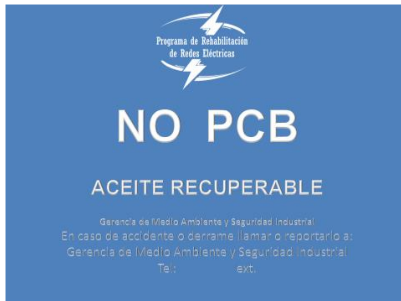
Ilustración 3. Etiqueta para Transformadores que NO PCB
